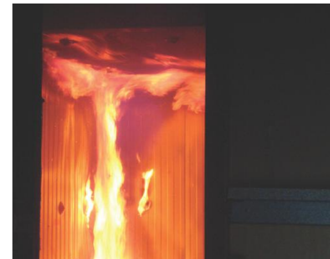
Ensayo Room Test UBC 26-3. A los 5 minutos el fuego está completamente desarrollado, la temperatura asciende rápidamente y las llamas atacan el techo.
