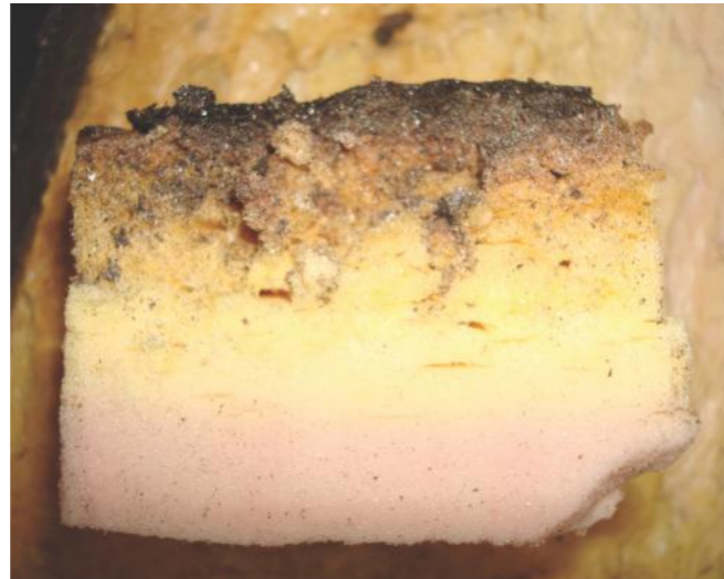
Aislante PIRM CLASE 1 tras ser sometido a la acción del fuego por una de sus caras. Se observa la carbonización superficial que protege el núcleo interior del aislante.
