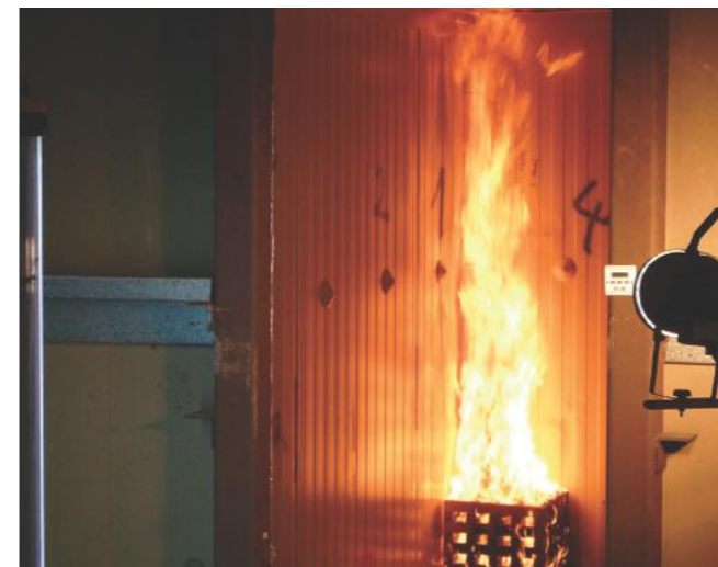
Ensayo Room Test UBC 26-3. A los pocos segundos de iniciarse el fuego, las llamas ya atacan con fuerza los paneles de las paredes y la junta de esquina.
