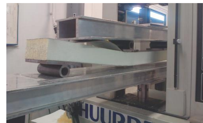
HUURRE realiza, como parte de su control de calidad, frecuentes ensayos a rotura por flexión de los paneles que fabrica.
