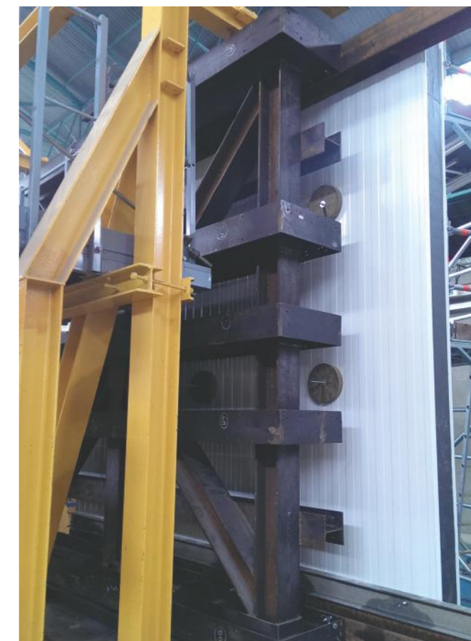
Ensayo estructural a gran escala en el laboratorio del CSTB, para la certificación del panel HI-F PIRM CLASE 1 para zonas sísmicas.
