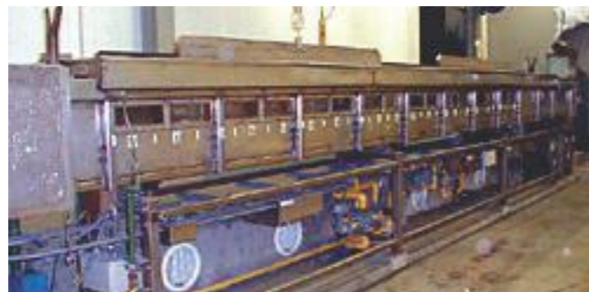
Ensayo en túnel ASTM E84, para la caracterización de la propagación de la llama y humos del núcleo aislante.
