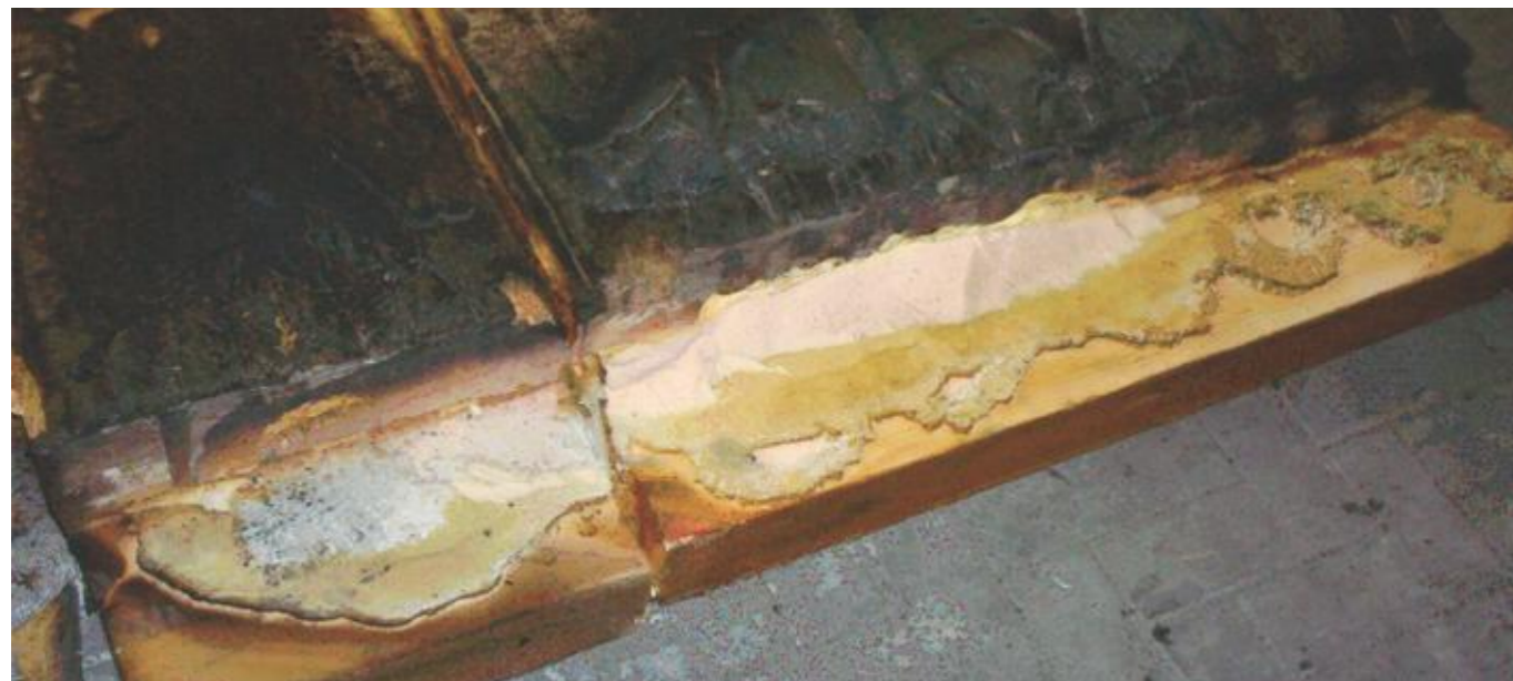
Núcleo aislante de dos paneles HI-F PIRM CLASE 1 tras ser sometidos a un fuego extremadamente potente. Se observa como se produce una carbonización únicamente superficial que no afecta al núcleo interior del aislante.
