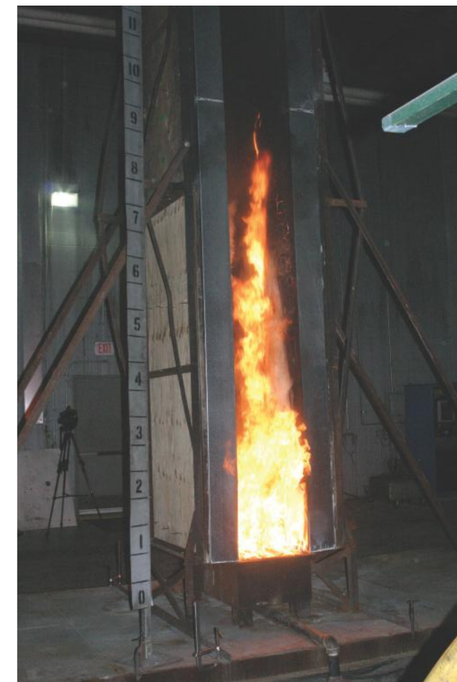
Ensayo Parallel Test. Los resultados de este ensayo han permitido ampliar la certificación <FM Approved> CLASE 1, sin límite de altura ni sprinklers.
